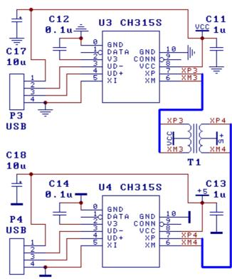
上图是由两组 CH315S 实现的简化版 USB 隔离延长线。
