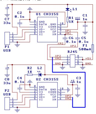
上图是由两组 CH315S 实现的电容耦合 USB 延长线。
