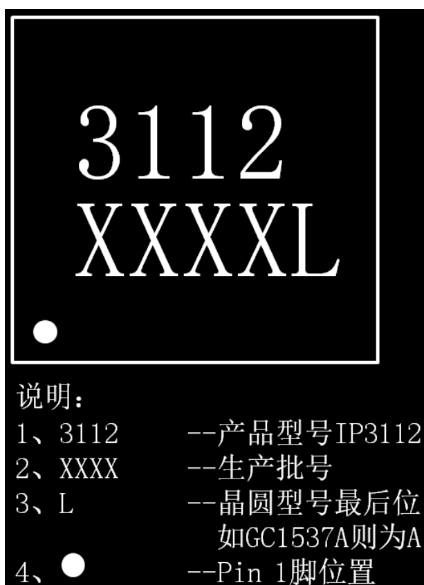
图 11: IP3112 IC 丝印说明
