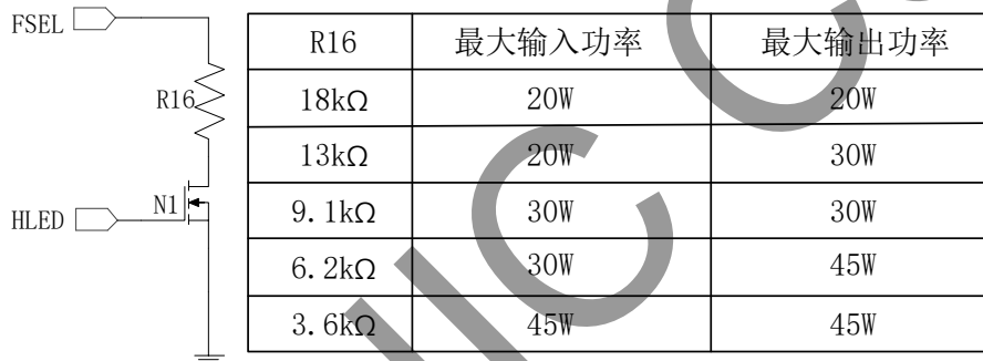
图 15 功率配置连接电路
