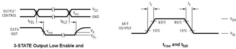
**FIGURE 2. Waveforms**
